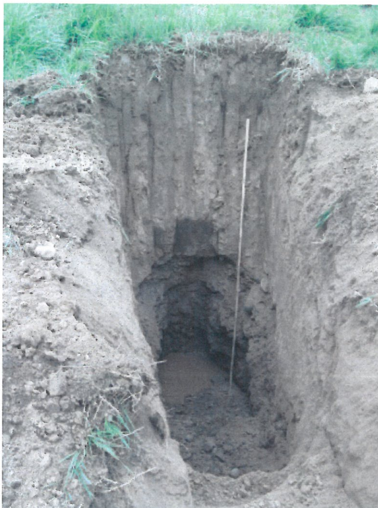
FOTO 3: La sezione del pozzetto esplorativo, dove è stata raggiunta la profondità di 2,4 m dal p.c.
